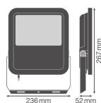
**Scheda tecnica Ledvance Proiettore LED 100 Aluminium Bianca 69W 9150lm 100D - 830 Luce Calda - | IP66 - Simmetrico**
