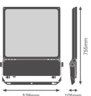
**Scheda tecnica Ledvance Proiettore LED Flex Bianca 450W 70000lm 45x140D - 840 Bianco Freddo | IP66 - Dali Dimmerabile - Asimmetrico**
