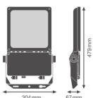
**Scheda tecnica Ledvance Proiettore LED Flex Bianca 80W 8300lm 45x140D - 822 Bianco Molto Caldo | IP66 - Asimmetrico**
